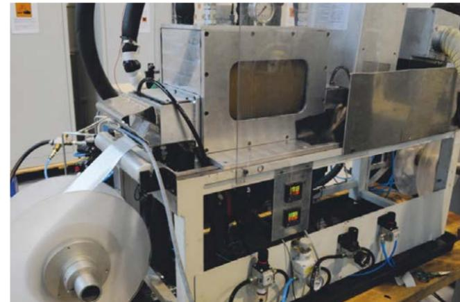
Sistema de impregnación de fibra de vidrio y curado on-line
